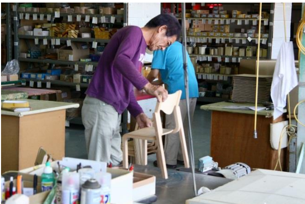
⑧仕上げは人の手によって研磨や細部のチェックが行われる
