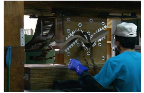
③圧力をかけ接着しながら曲げ加工を施す
