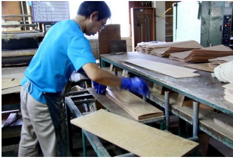
①スライスした単板を接着剤で何枚も重ね合わせる
