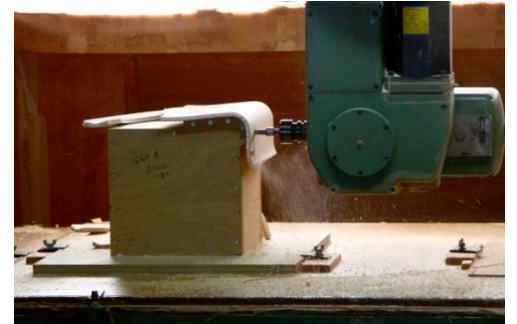
⑥オリジナル設計の工作機械で合板に穴を開ける
